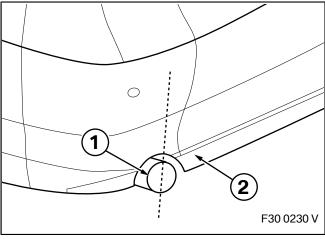
Bei der Montage und auch im Fahrzeugbetrieb (thermische Ausdehnung der Abgasanlage), ist darauf zu achten, dass die Endrohrblende (1) nicht über die Heckschürze (2) herausragen darf (Verbrennungsgefahr!). ◀
