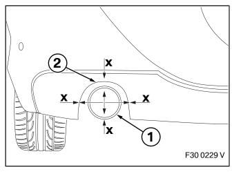
Lage der Endrohrblende (1) zur Kontur (2) der Heckschürze prüfen, gegebenenfalls ausmitteln und ausrichten.
