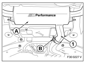
Torca-Schelle **B** über das Rohr (1) von M Performance Schalldämpfer **A** schieben.
