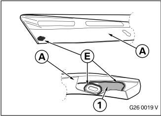
Die Flächen (1) von Frontaufsatz Carbon rechts **A** und von Frontaufsatz Carbon links **C** mit geeigneten Mitteln anschleifen und mit Reiniger **F** reinigen.
