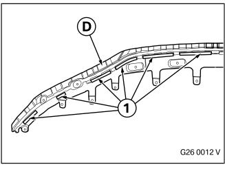
Die Schutzfolien (1) der Klebebänder auf der Unterbaukonsole **D** komplett entfernen.
