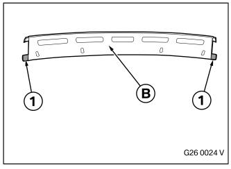
Die kleinen Flächen (1) auf Frontaufsatz Carbon Mitte **B** mit geeigneten Mitteln anschleifen und mit Reiniger **F** reinigen.
