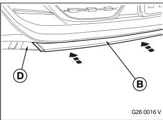
Austretenden Flüssigklebstoff sofort mit geeigneten Mitteln entfernen.
