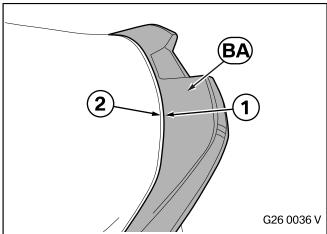
Den Verlauf der Kontur (1) des Heckspoilers Carbon **BA** mit der Kontur (2) der Heckklappe überprüfen.
