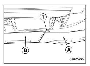
Austretenden Flüssigklebstoff sofort mit geeigneten Mitteln entfernen.
