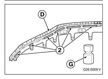
Den Primer **G** mit geeigneten Mitteln auf die Schutzfolien der Klebebänder (1) der Unterbaukonsole **D** auftragen.
