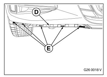
Auf den angeschliffenen kleinen Flächen den Flüssigklebstoff **E** raupenförmig auftragen.
