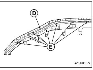
Jeweils auf die angeschliffenen Flächen der Unterbaukonsole **D** den Flüssigklebstoff **E** punktförmig auftragen.
