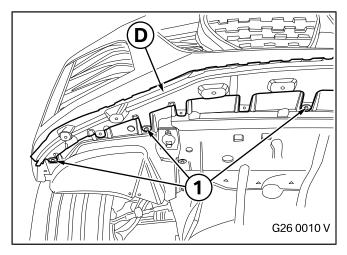
Die Unterbaukonsole **D** aufsetzen und mit sechs vorhandenen Schrauben (1) fixieren.
