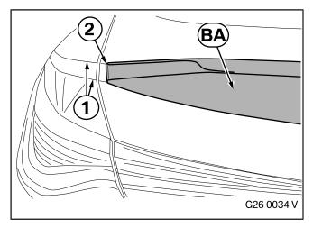
Den Heckspoiler Carbon **BA** anhand der Kontur (1) auf die Heckklappe aufsetzen.
