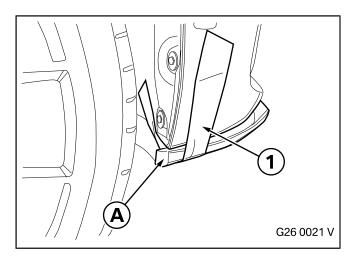
Die Enden von Frontaufsatz Carbon rechts **A** und von Frontaufsatz Carbon rechts **C** mit geeignetem Klebeband (1) fixieren.
