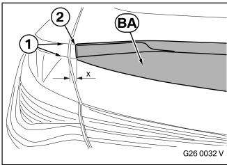
Den Heckspoiler Carbon **BA** mit einer zweiten Person an die Heckklappe halten und an den Kanten (1) ausrichten. Darauf achten, dass der Abstand **x** links und rechts identisch ist und mit einem wasserlöslichen Stift auf beiden Seiten eine Markierung (2) auf die Heckklappe zeichnen.
