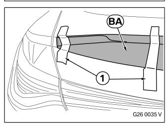
Den Heckspoiler Carbon **BA** mit geeigneten Klebebändern (1) an mindestens fünf Stellen fixieren. Dabei ein Klebeband ganz außen anbringen, um bestmöglichen Formschluss des Heckspoilers mit der Heckklappe zu gewährleisten.
