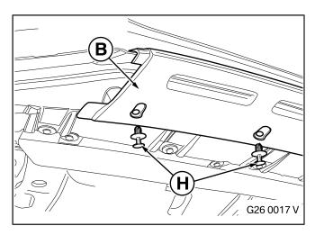
Die vier Spreizniete **H** von unten in die Langlöcher von Frontaufsatz Carbon Mitte **B** einschieben und festdrücken.
