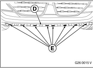
Auf den kleinen angeschliffenen Flächen von Unterbaukonsole  ${\bf D}$  wie dargestellt den Flüssigklebstoff  ${\bf E}$  raupenförmig auftragen.
