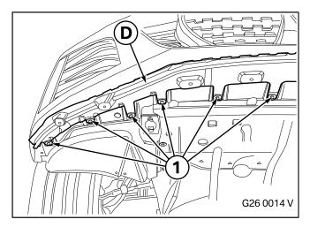
Die Unterbaukonsole **D** aufsetzen und die vorhandenen Schrauben (1) einschrauben.
