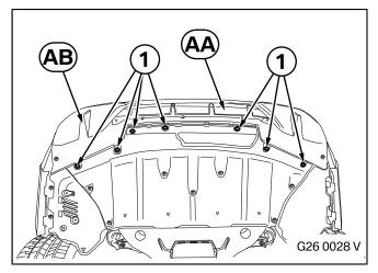
Den Zusammenbau aus Blende Stoßfänger schwarz Hochglanz **AB** und Heckdiffusor Carbon **AA** analog der Serienblende montieren und die sieben vorhandenen Schrauben (1) wieder einschrauben.
