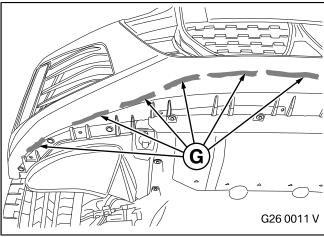
Den Primer **G** sehr akurat auftragen, da dieser die Stoßfängerverkleidung schwarz verfärbt und nicht mehr entfernt werden kann. ◀
