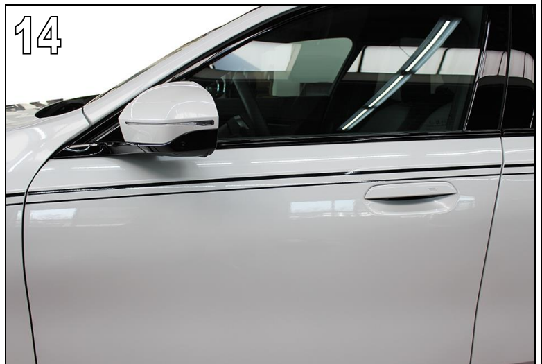
Abb. 14 Fertig verklebter AC Schnitzer Designstreifen Tür.
