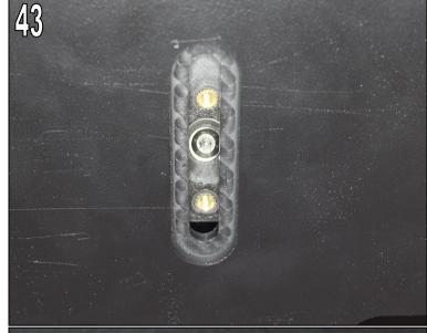
**Abb. 44**AC Schnitzer Mittelsteg mit den **M6x16mm** festschrauben. Anschließend die Linsenkopfschraube **M6x40mm** festziehen.
