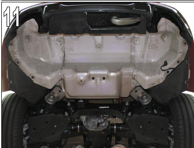
Abb. 11 Hitzeschutzbleche Links, Mitte, Rechts ausbauen.
