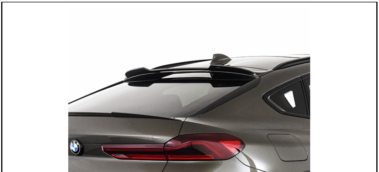
3) Dachheckflügel / rear roof wing
